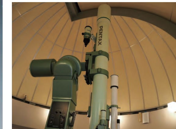
開館当初からある口径200mmの屈折赤道儀式天体望遠鏡。屋根はドーム式で天体観測時には開くようになっている
